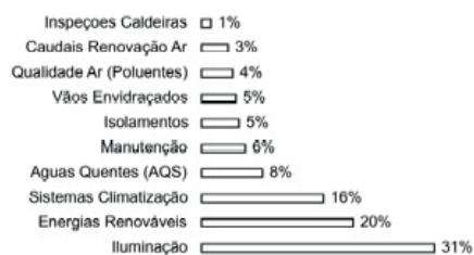
Fig. 2 Incidência das Medidas de Melhoria em Edifícios, destaque à iluminação.
